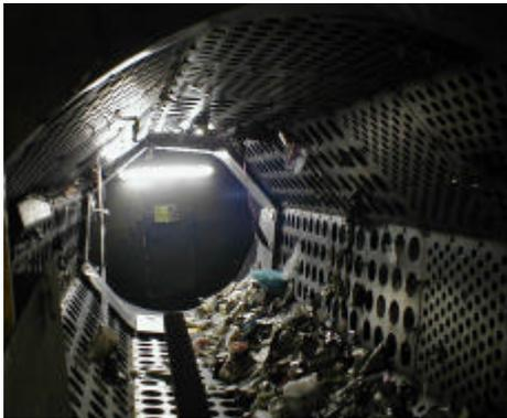
Sur la chaîne des corps creux, un aimant puis un séparateur d'aluminium prélèvent les objets métalliques.
